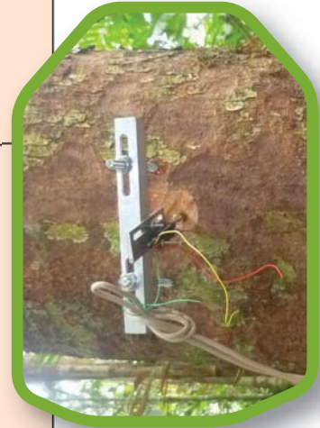
Montura de aluminio para fijar el dendrómetro al árbol. Notar resorte y tope en contacto con el xilema del árbol.
