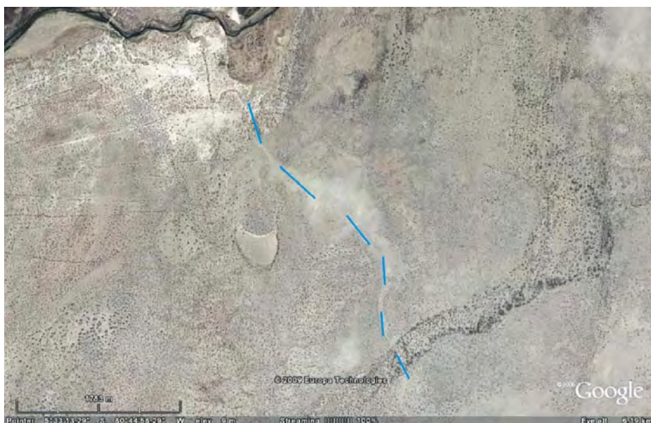
Fig. 3.25. Cauce avulso que funciona solamente durante inundaciones grandes o intensas y conecta cauce original de Río Piura, que pasa por la ciudad Sechura, con la depresión endorreica de Pampa Las Salinas.
