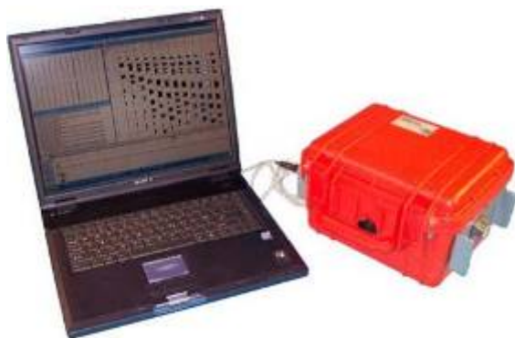
Figura a: Equipo ES-3000 conectado a Computadora Portátil para la realización de Ensayo de Refracción Sísmica
