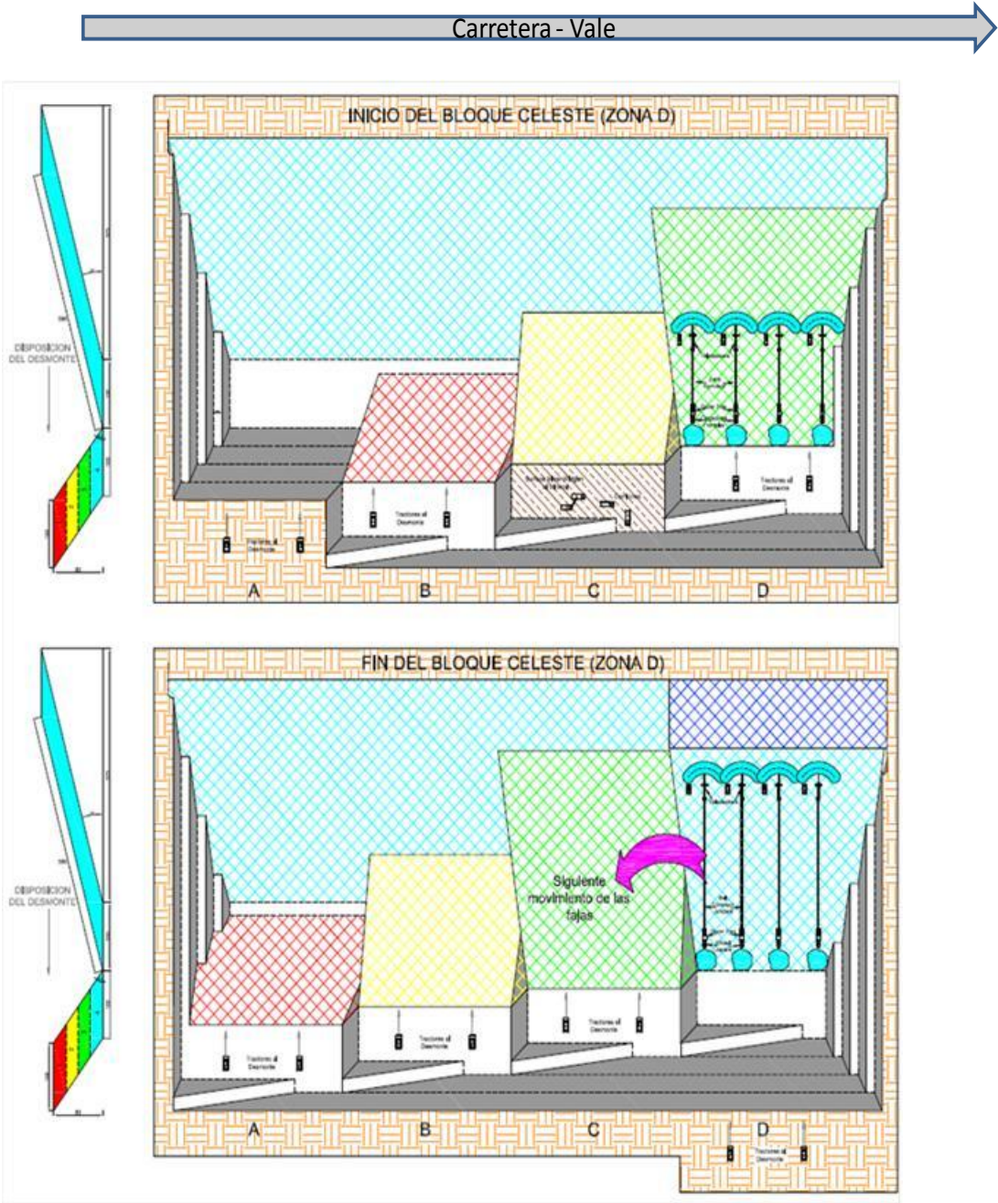
Figura 4.4.3.2-12. Vista horizontal como se forman los diferentes bloques de explotación y la disposición del movimiento de desmonte en la cara opuesta
