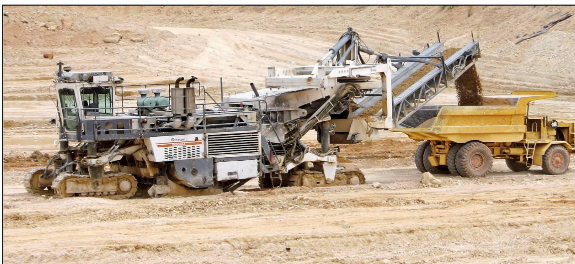
Figura 4.4.3.2-7. Corte y carguío del mineral con Surface Miners a volquetes
