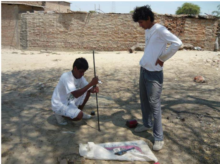
**FOTO N° 14:** Realización de ensayos “DPL”. La investigación con este equipo ha sido eficiente tomando en cuenta las características de suelo arenoso existente en la zona de estudio.
