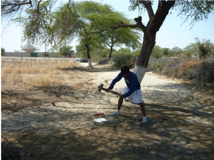
**FOTO N° 03:** Realización del Ensayo de Refracción Ssmica (LS.01) en la ciudad de Castilla. Se ha utilizado una fuente sísmica con un impacto con martillo de 25 Lb.
