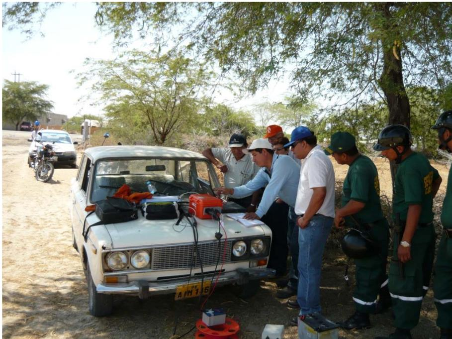
**FOTO N° 04:** Realización del Ensayo de Refracción Ssmica (LS.01) en la ciudad de Castilla. Se ha utilizado una Equipo sismógrafo ES-300.
