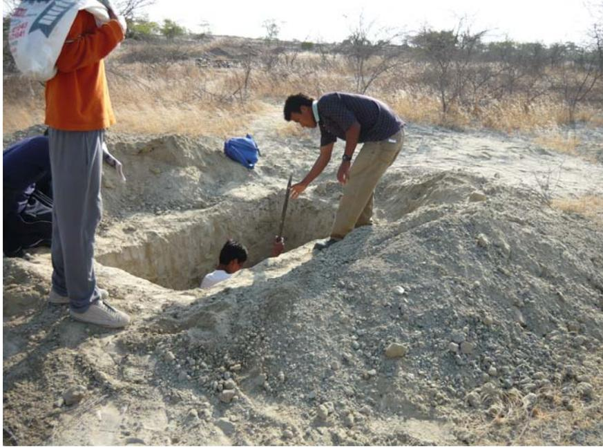
**FOTO N° 11:** Excavación de “calicatas” de hasta 3.0 m. de profundidad en los distritos de Piura y Castilla. En total se han realizado 15 “calicatas”, siendo el material predominante un suelo areno a areno-limoso de pobre gradación y en estado de compacidad Suelto.
