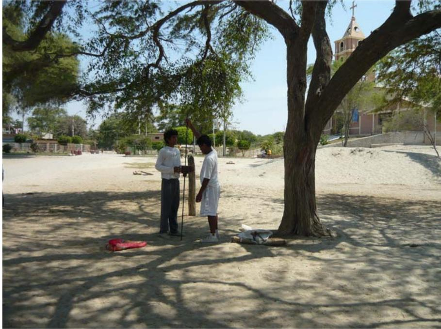
**FOTO N° 13:** Realización de ensayos dinámicos de penetración ligera (DPL) de hasta 3.0 m. de profundidad en los distritos de Piura y Castilla. En total se han realizado 37 “DPL”, siendo el estado de compacidad preferente el Suelto y con un ángulo de fricción interna no mayor a 30°.
