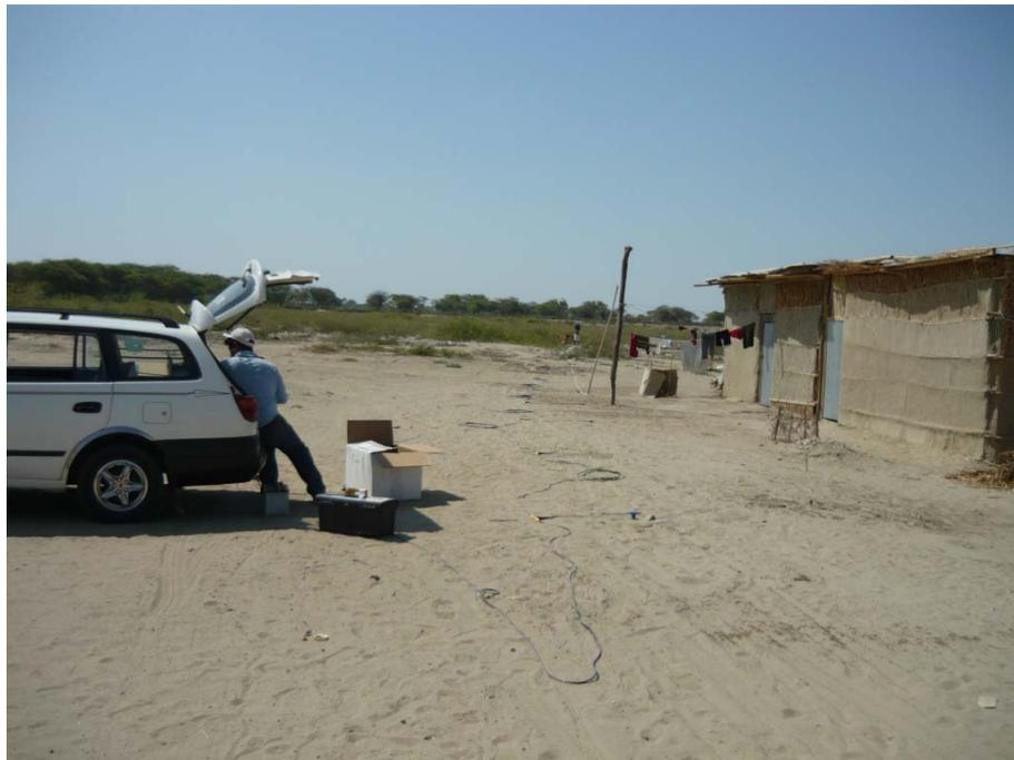
**FOTO N° 08:** Realización del Ensayo de Refracción Sísmica (LS-03) en la ciudad de Piura en la zona de Los Polvorines. Tendido de cables y geófonos.
