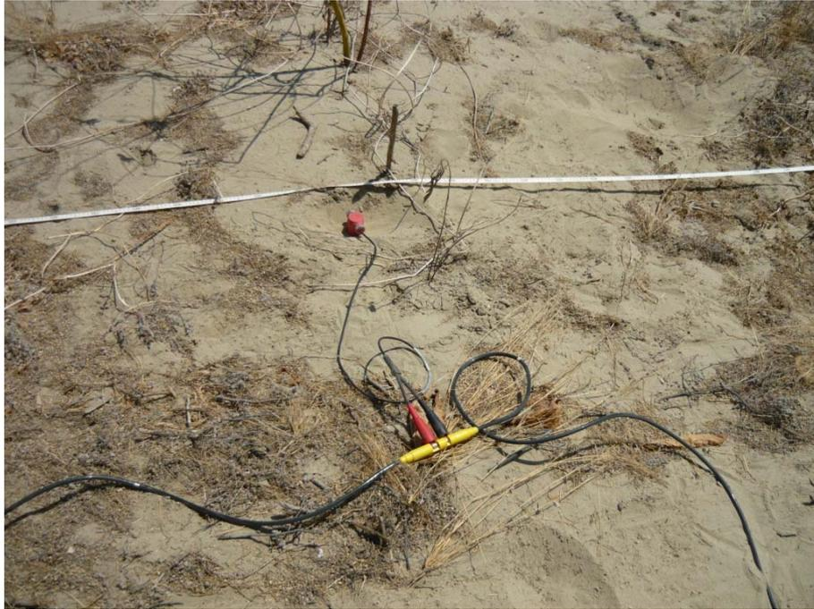
**FOTO N° 05:** Realización del Ensayo de Refracción Ssmica (LS.01) en la ciudad de Castilla. Se ha utilizado geófonos de 4.5 Hz y la técnica del MASW.
