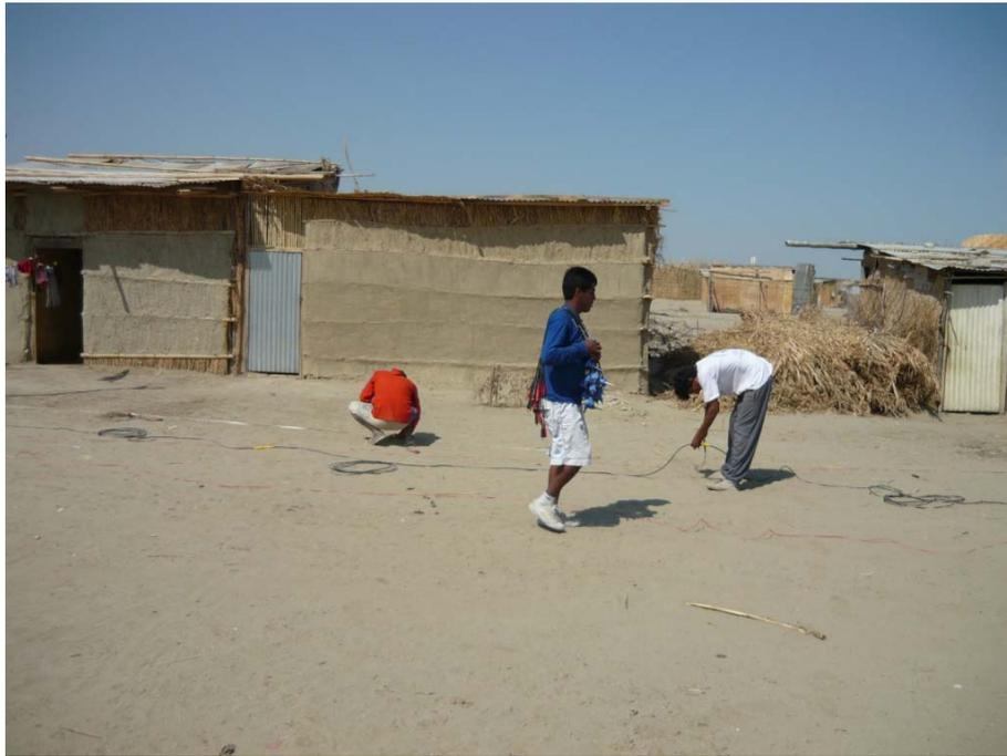
**FOTO N° 07:** Realización del Ensayo de Refracción Sísmica (LS-03) en la ciudad de Piura en la zona de Los Polvorines. Tendido de cables y geófonos.
