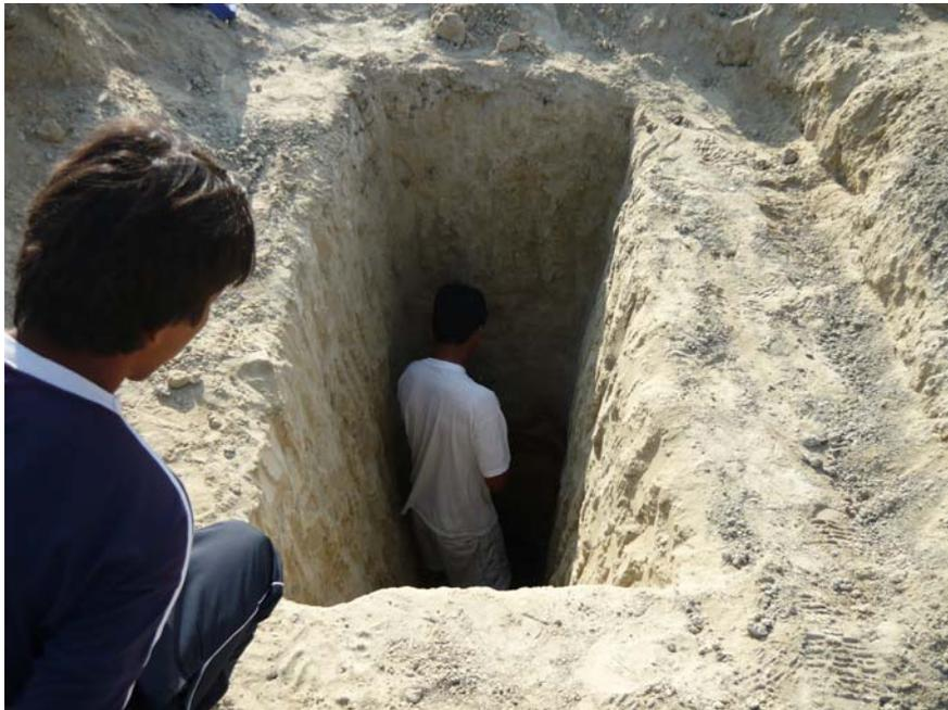
**FOTO N° 12:** Muestreo de suelos en las 15 “calicatas” excavadas en los distritos de Piura y Castilla. Las muestras extraídas se han llevado a Laboratorios especializados para la realización de ensayos físicos y químicos.
