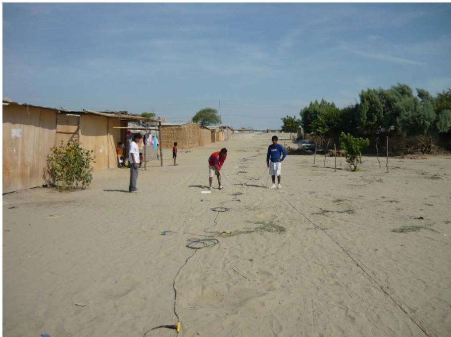
**FOTO N° 10:** Realización del Ensayo de Refracción Sísmica (LS-04) en la ciudad de Piura en la zona de Los Polvorines. Generación de la onda sísmica.
