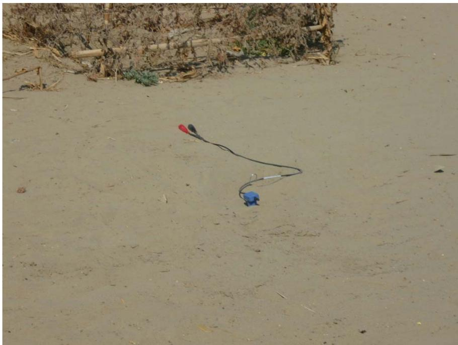
**FOTO N° 06:** Realización del Ensayo de Refracción Ssmica (LS.01) en la ciudad de Castilla. Se ha utilizado geófonos de 14.0 Hz y la técnica de Refracción Sísmica.
