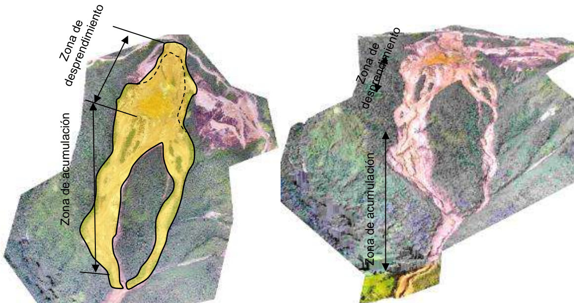
Figura 22. Vista en planta y perspectiva del deslizamiento y las zonas de desprendimiento y acumulación.
