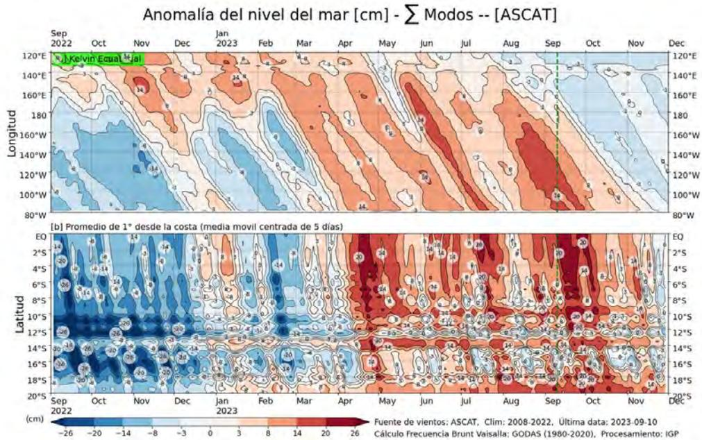
**Figura 42.** Anomalía del nivel del mar (en cm) para la sumatoria de los modos (modo 1, 2 y 3) simulado a partir del Modelo Oceánico Multimodal (MOMM-IGP; Urbina y Mosquera, 2020) en la franja ecuatorial (superior) y costera (inferior), forzado con vientos de ASCAT. La línea verde representa el inicio del pronóstico con vientos igual a cero.
