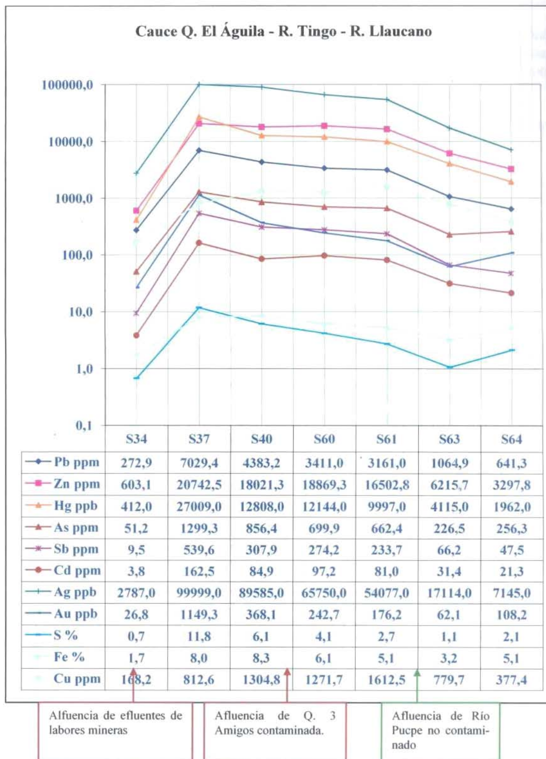
Figura 3.45. Plomo, Zinc, Mercurio, Arsénico, Antimonio, Cadmio, Plata, Oro, Azufre, Hierro y Cobre en sedimentos tomados en cauce: Q. El Águila-R.Tingo-R.Llaucano. Sub-cuenca: R. Tingo-Maigabamba.
