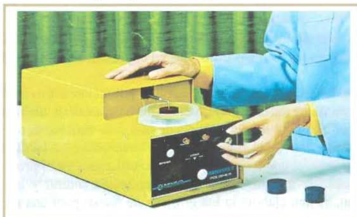
Figura 2.6. Pulidora utilizada para pulir la briqueta.
