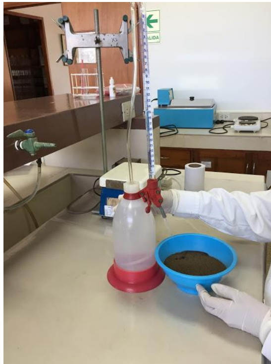
Figura 26. Saturación de muestra con agua desionizada. Fuente: Elaboración propia.
