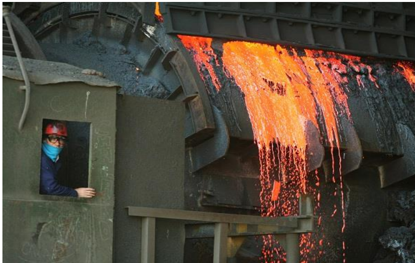
Figura 8. Fundición pirometalúrgica del cobre.
