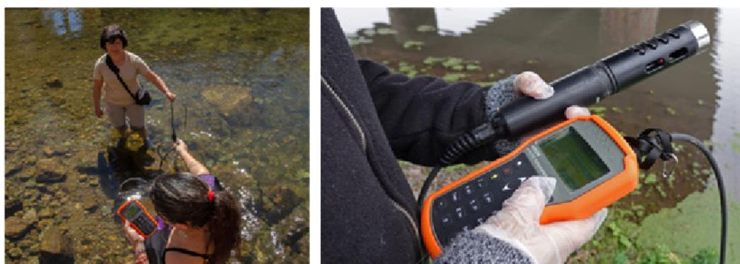
**Figura 3.** (Izq.) Medición de parámetros físico-químicos por medio de una sonda multiparámetro. (Der.) Sonda Multiparámetro.
