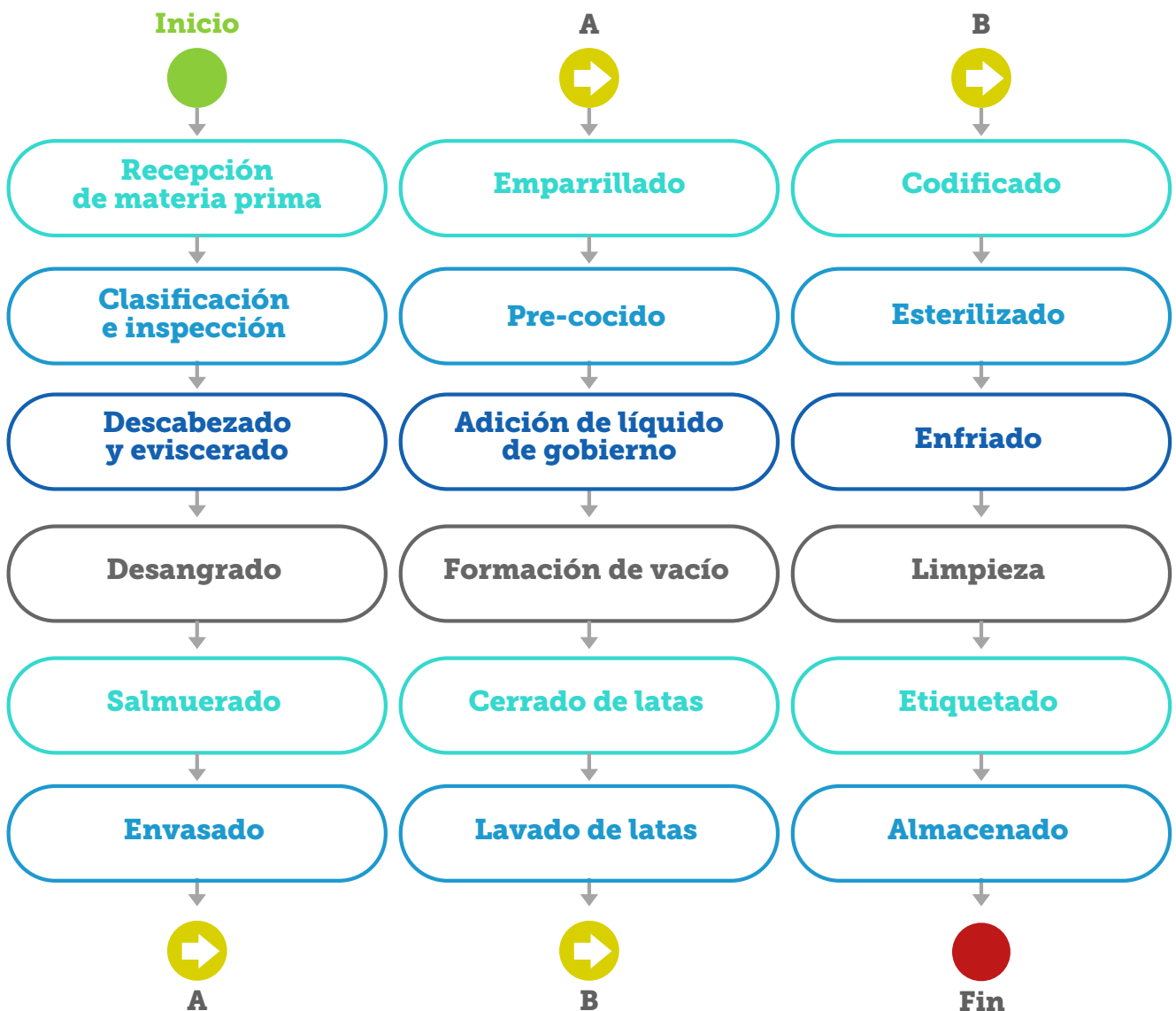
Figura 7. Diagrama de flujo del proceso de enlatado línea crudo
