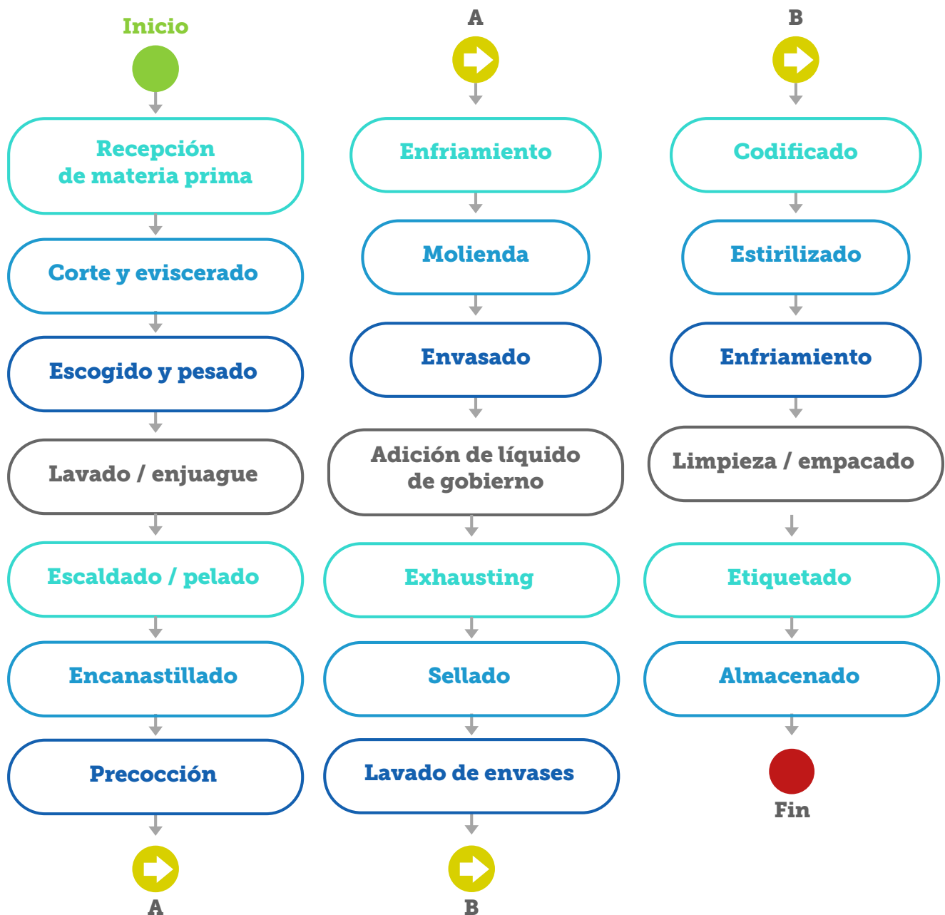
Figura 6. Diagrama de flujo del proceso de enlatado línea cocido
