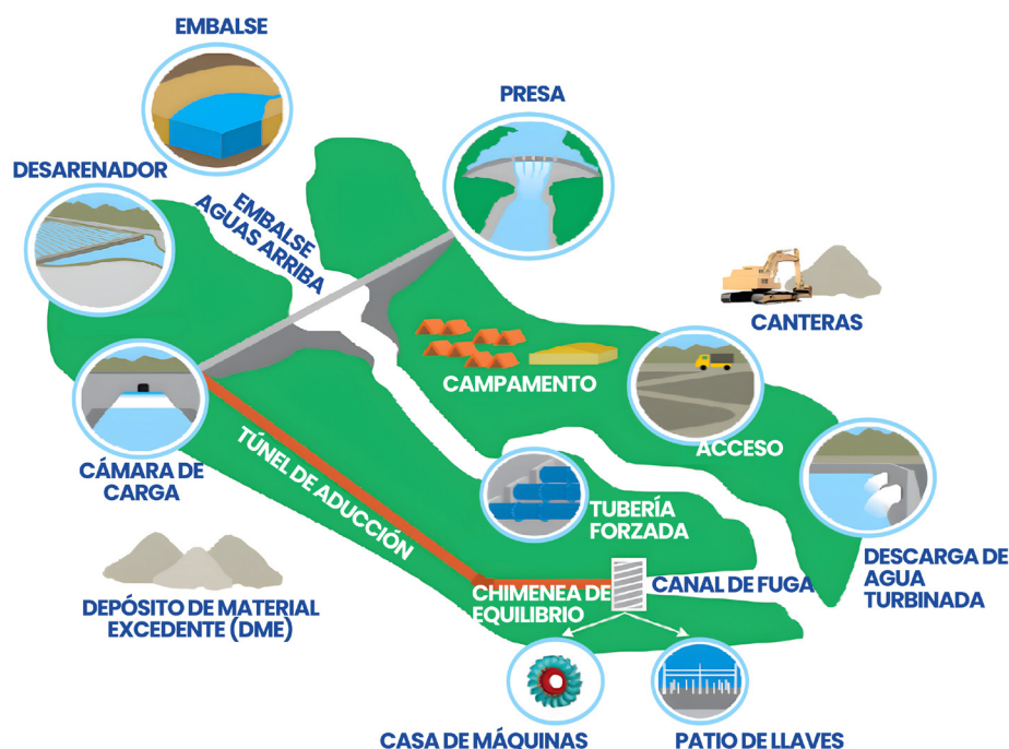
Figura 2. Esquema de una central hidroeléctrica en construcción
