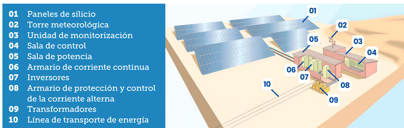
Figura 7. Diagrama de central fotovoltaica
