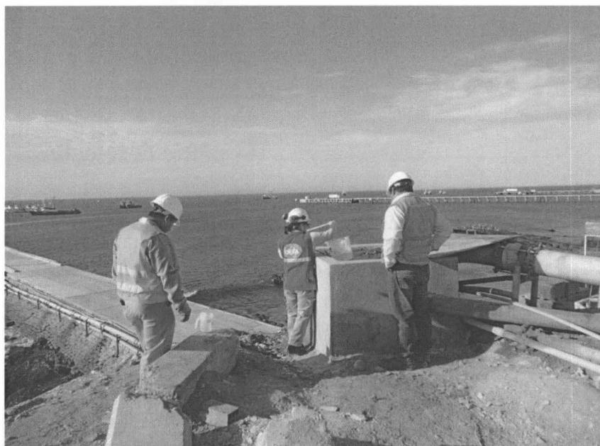
**Fotografía 2:** Toma de muestra de efluente en el punto de muestreo E-2. Punto de muestreo E-2. Caja de registro posterior al sistema de tratamiento de efluentes de la planta de congelado y planta de harina residual. Industrial Pesquera Santa Mónica S.A.
