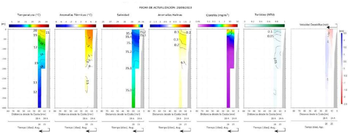
**Figura 20.** Sección vertical de temperatura (°C), anomalías térmicas (°C), salinidad, anomalías halinas, clorofila-a ( $\text{mg m}^{-3}$ ), turbidez (NTU) y flujos geostrofos ( $\text{cm s}^{-1}$ ) del glider Mochica en su recorrido frente a Negritos – Talara, registrados del 24 al 28 de agosto.
