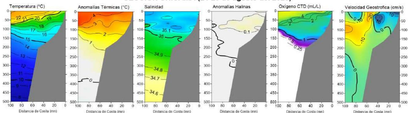
**Figura 22.** Secciones oceanográficas de temperatura, anomalía térmica salinidad, anomalía halina, oxígeno disuelto y velocidad geostrofica, realizadas frente a Paíta y a Chicama, dentro de las 100 mn, entre el 24 y el 28 de agosto de 2023. Climatología: 1991-2020 (Domínguez et al., 2023).
