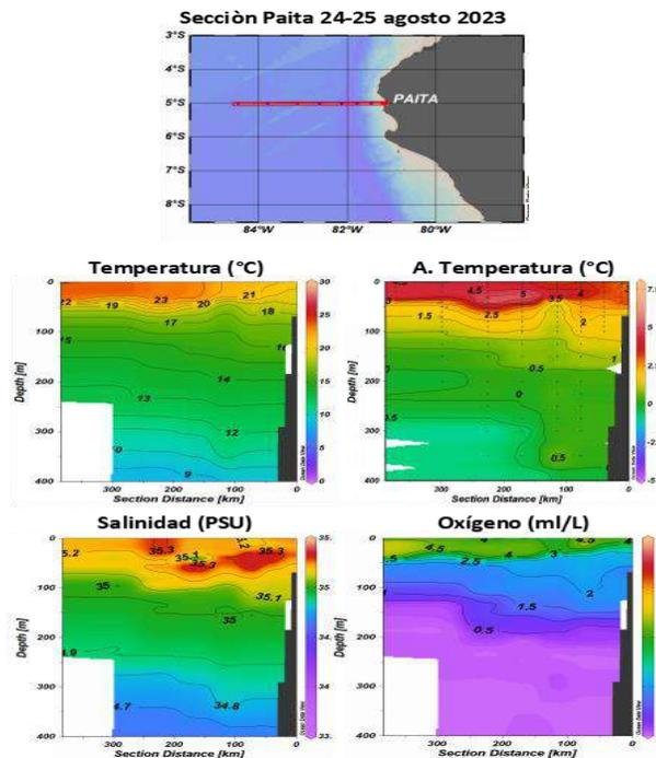
**Figura 26.** Perfiles de temperatura, anomalía de temperatura, salinidad y oxígeno disuelto registrados por el BAC CARRILLO durante el crucero oceanográfico de la marina de guerra del Perú "Cruc0823" Paita (24-25 agosto). Fuente y elaboración: DIHIDRONAV.
