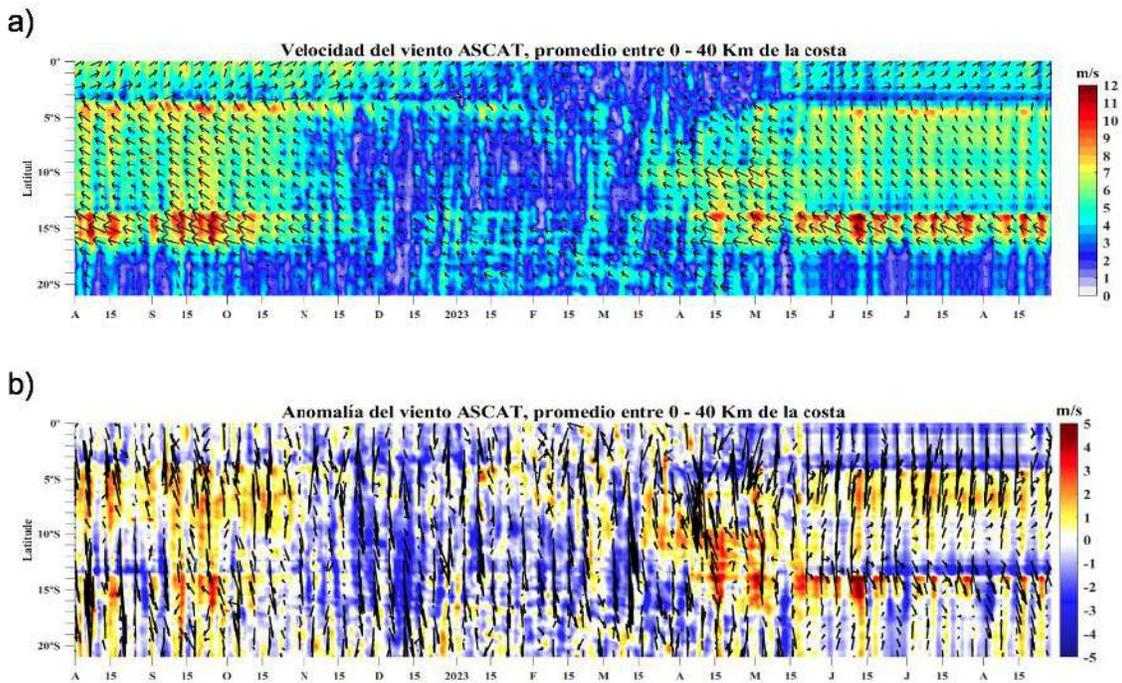
**Figura 11.** Viento Satelital (40 km frente a la costa del Perú): a) Velocidad del viento ( $\text{m s}^{-1}$ ), b) Anomalia de la velocidad del viento ( $\text{m s}^{-1}$ ) Procesamiento: Laboratorio de Hidro-Física Marina y Laboratorio Costero de Santa Rosa, IMARPE. Climatología 2000-2014. Actualizado al 28 de agosto.
