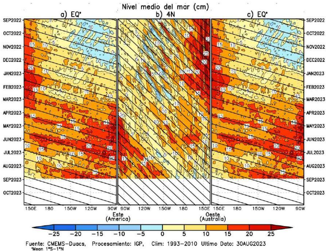
**Figura 4.** Diagrama Hovmöller de la anomalía del nivel del mar del producto CMEMS-Duacs a lo largo de la línea ecuatorial (a y c) y en 4°N (b). El panel del centro tiene el eje de la longitud invertido para apreciar mejor la secuencia de ondas Kelvin y Rossby producidas por reflexión en las fronteras este y oeste del Pacífico. Las líneas negras inclinadas en cada panel indican la trayectoria teórica de la onda de Kelvin (a y c) y Rossby (b) del primer modo baroclínico. Elaboración: IGP.
