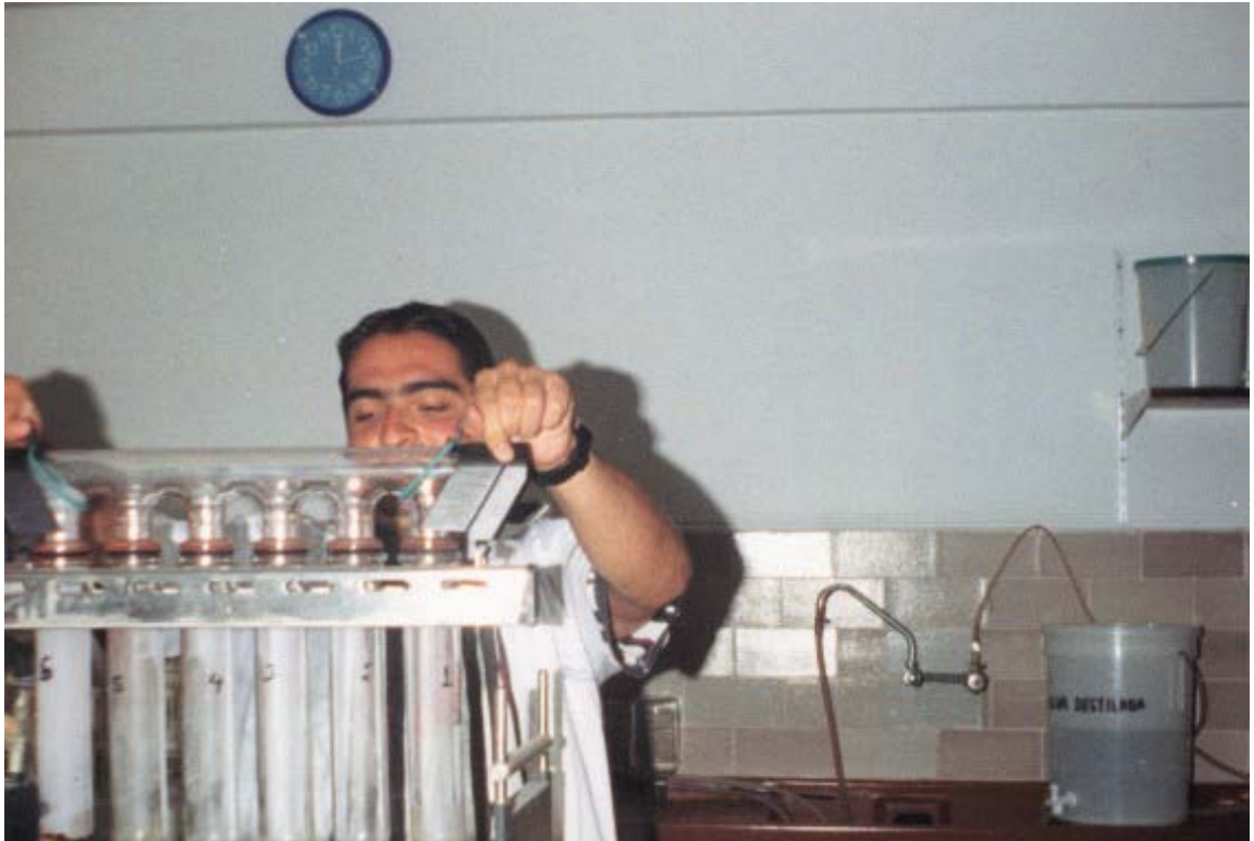
Foto 2.4 Determinación de nitrógeno: Tubos de digestión del sistema “Kjedhal”
