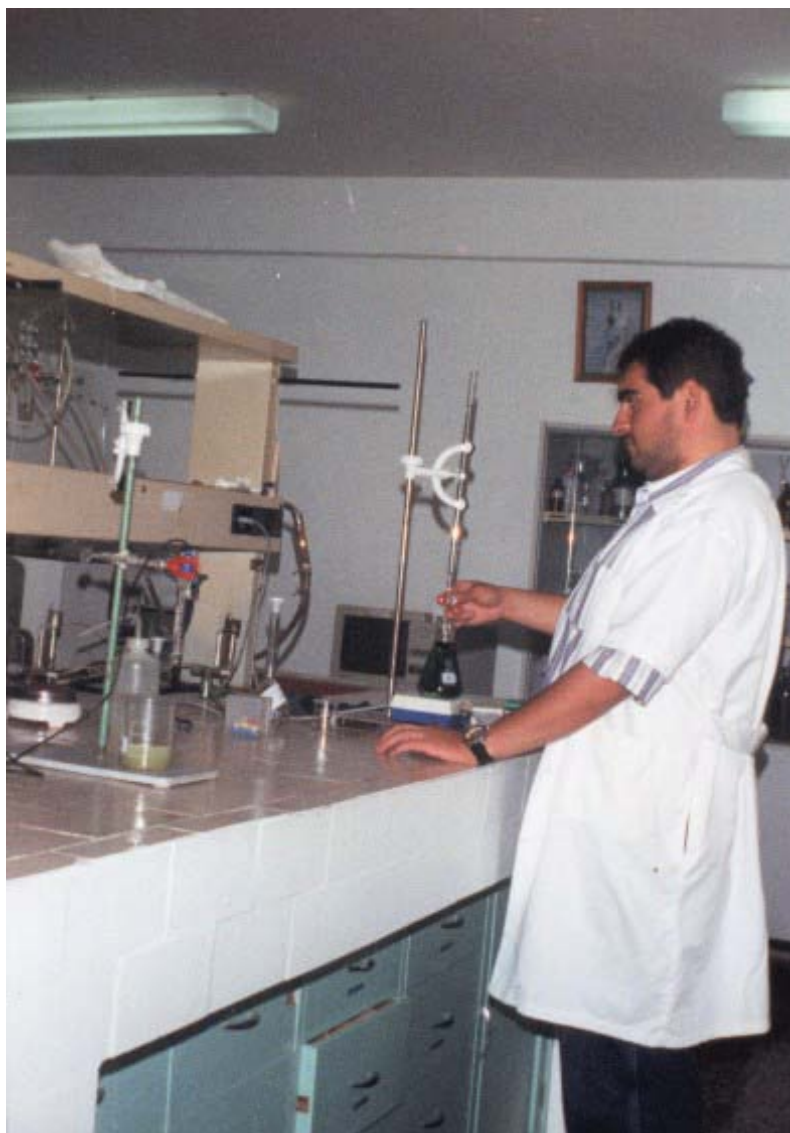
Foto 2.7 Determinación de nitrógeno: Titulación con ácido clorhídrico 0,1 N
