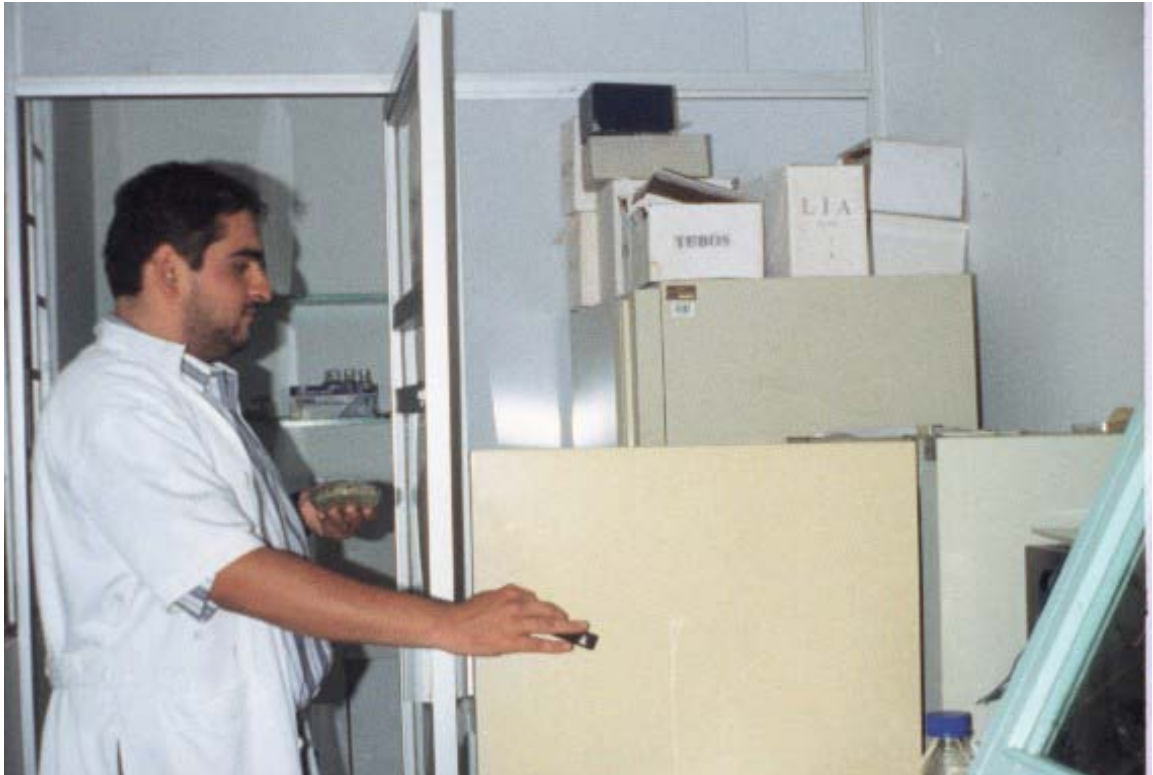
Foto 2.2 Determinación de humedad: Utilización de estufa para el secado de la muestra
