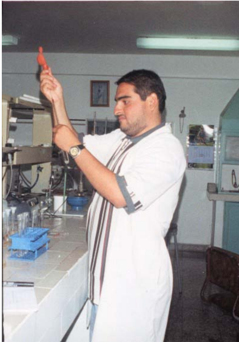
Foto 2.10 Determinación de fósforo: Toma de extracto en tubo de ensayo
