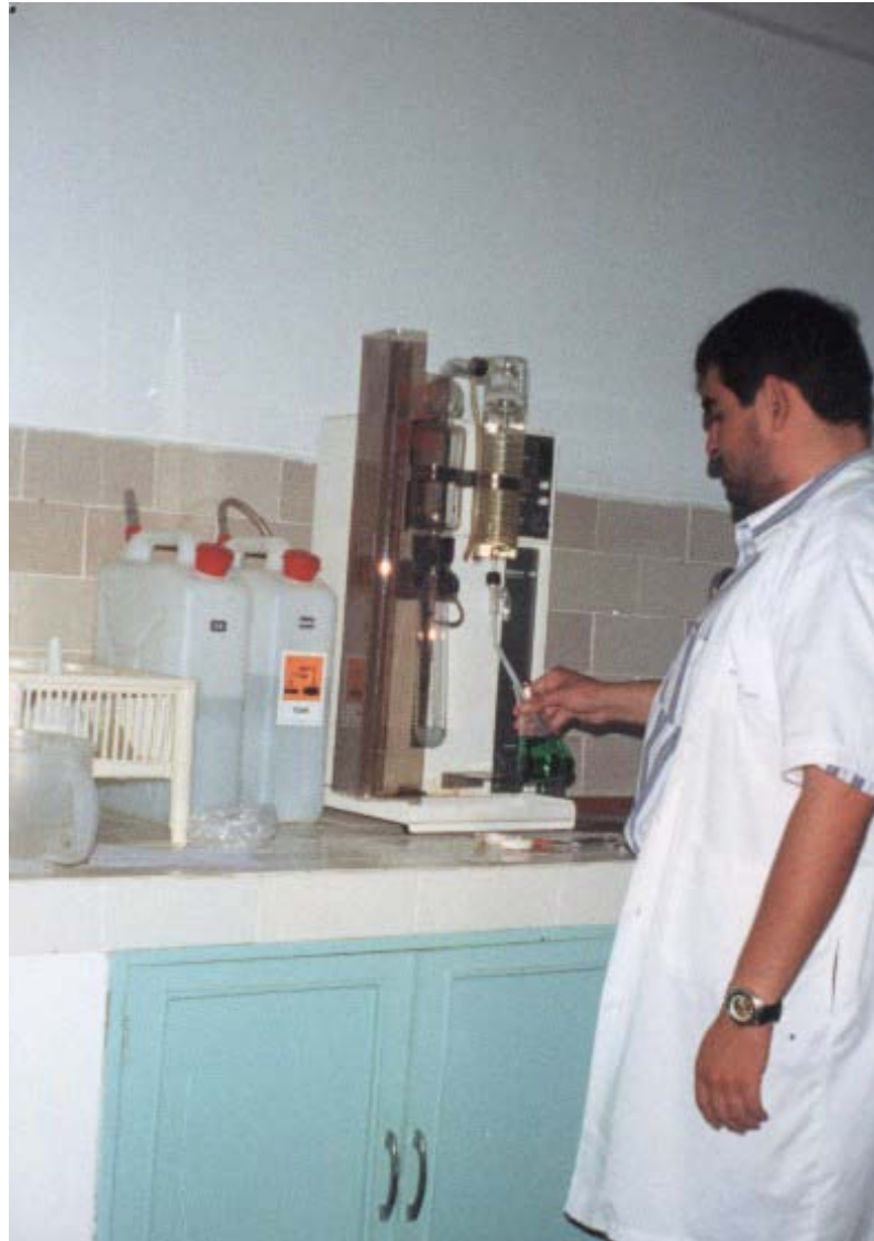
Foto 2.6 Determinación de nitrógeno: Retiro del frasco de erlenmeyer del sistema de destilación
