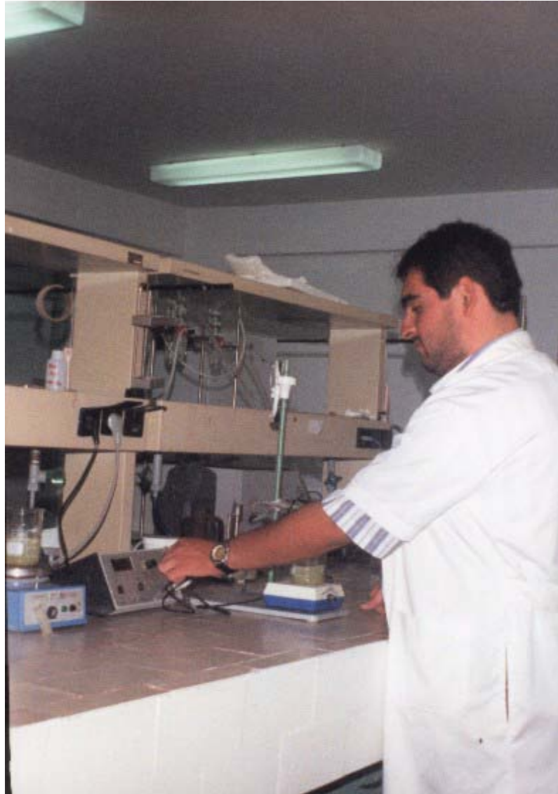
Foto 2.3 Lectura del potenciómetro para determinación de pH
