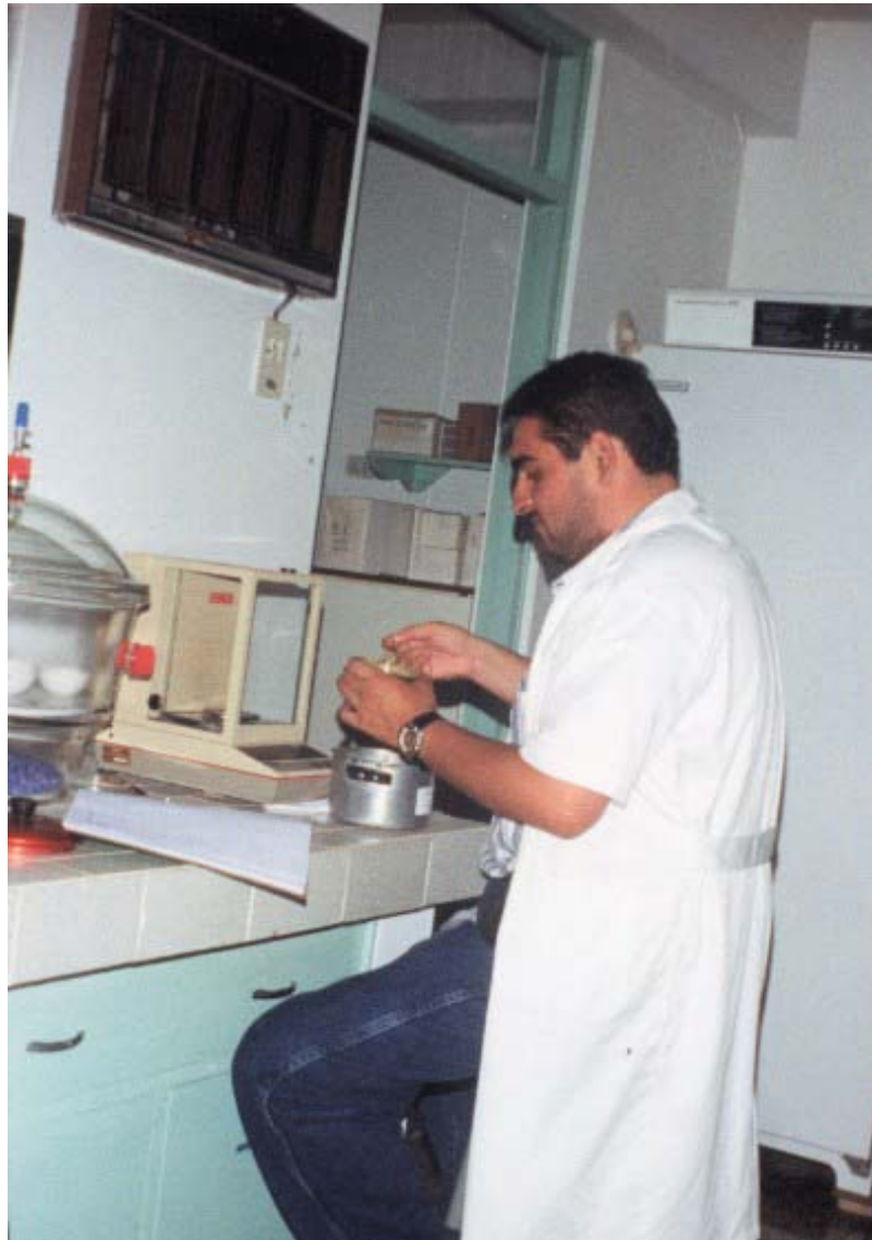
Foto 2.1 Determinación de humedad: Pesado de la muestra en placa petri
