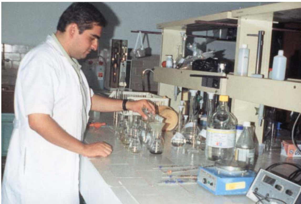
Foto 2.9 Determinación de fósforo: Filtrado en frasco de erlenmeyer de 125 ml
