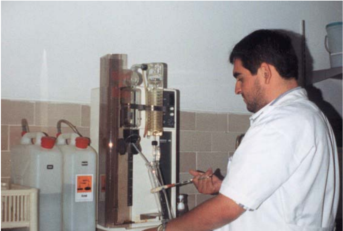
Foto 2.5 Determinación de nitrógeno: Retiro del tubo de digestión del sistema de destilación
