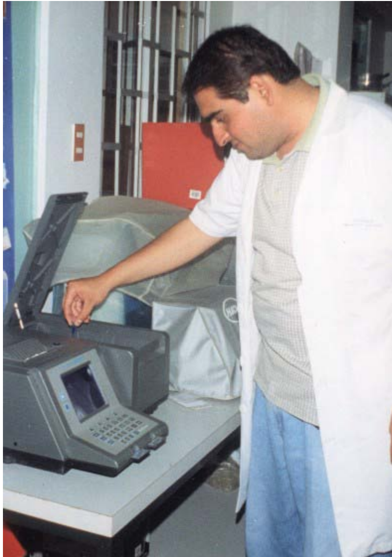
Foto 2.11 Determinación de fósforo: Colocación de las muestras en el espectrofotómetro
