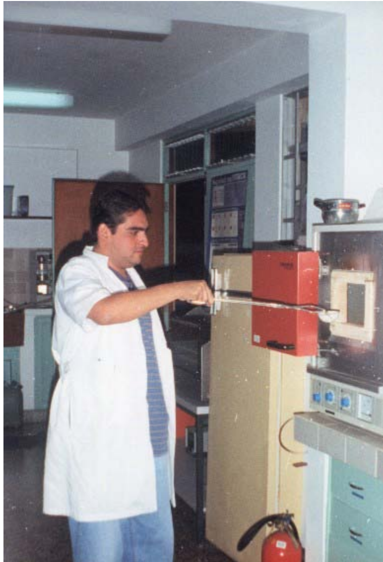
Foto 2.8 Determinación de cenizas: Retiro de los crisoles de la mufla
